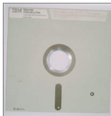
Figura 16. Primer modelo de disquete
